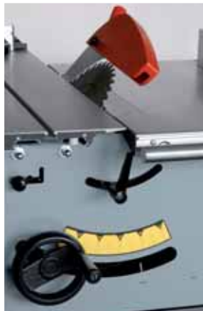
Lame inclinable à 45° et réglable en hauteur
