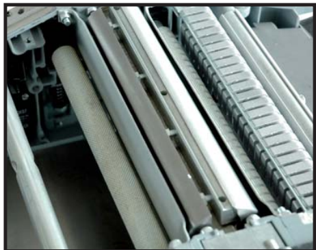
Rouleaux d'entraînement pour l'avance de la pièce de bois Automatic feed system
