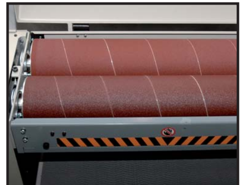
Double cylindre en aluminium avec gâchette de blocage rapide Double aluminum cylinder with quick locking system
