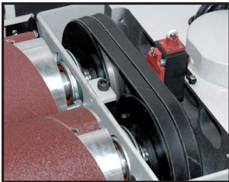
Ajustement du rouleau de sortie. Entraînement par double courroie crantée Rear drum adjustment. Double toothed belt drive drum
