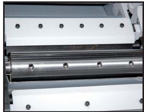
Arbre de dégauchissage de \varnothing 70 mm avec 3 fers 310x25x3 Planer shaft 70 mm with 3-knives 310x25x3
